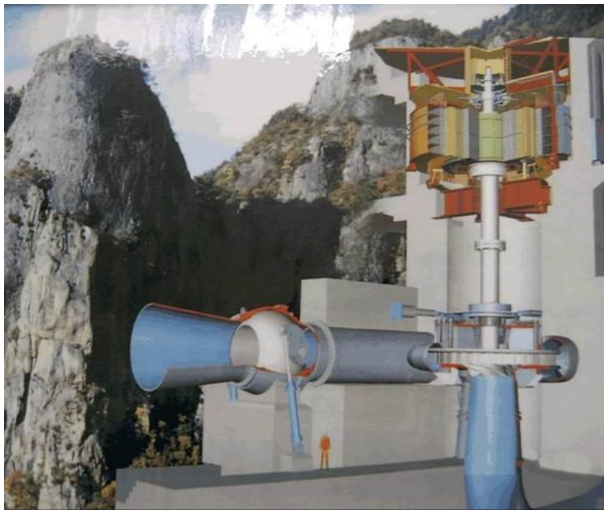
抽水蓄能机组
