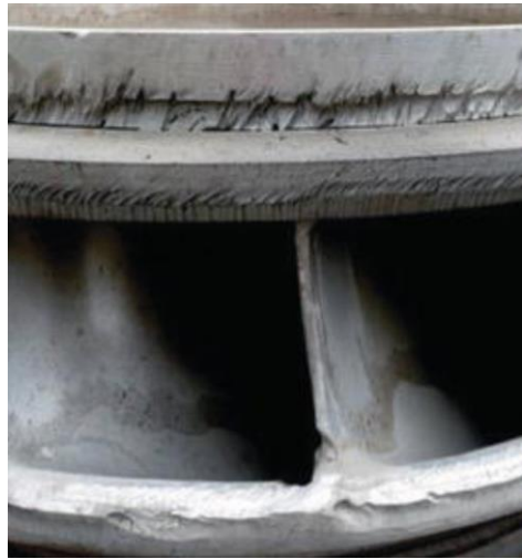
受到冲蚀破坏后的水轮机部件
