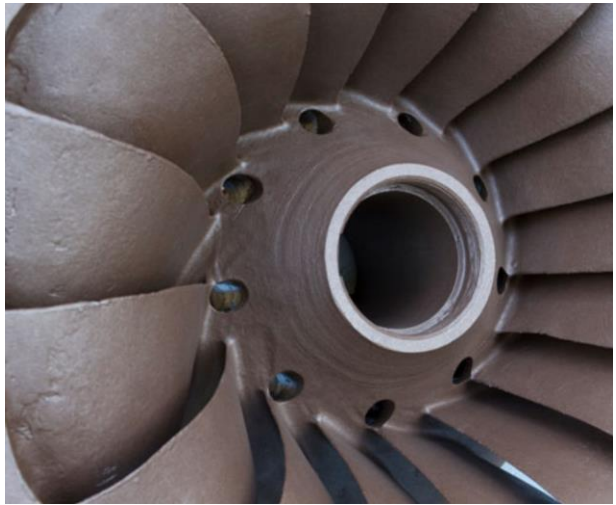
受到冲蚀破坏后的水轮机部件
