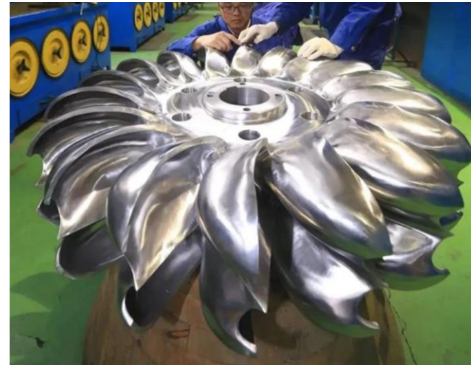
我国第一台 3D 打印冲击式水轮机转轮（哈电集团）
