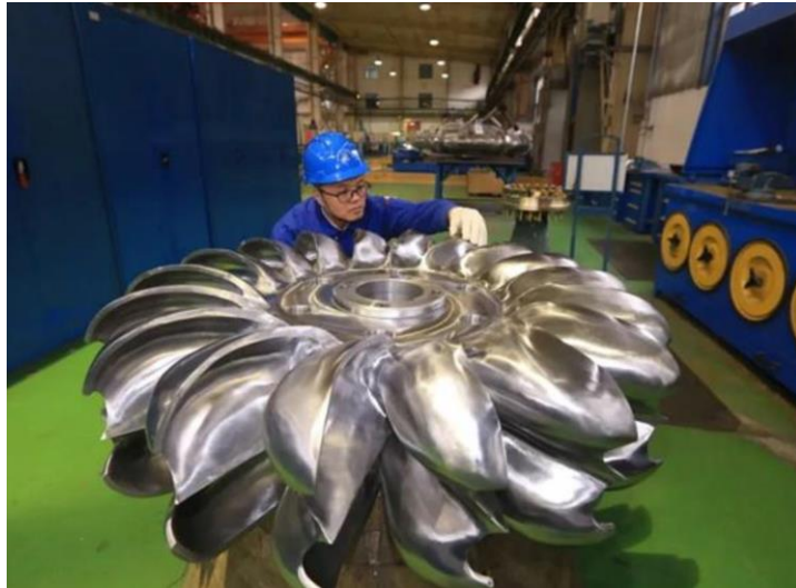
我国第一台 3D 打印冲击式水轮机转轮（哈电集团）
